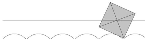
drate come nel disegno qui sopra, come dovrà essere la strada affinché chiunque si muova su un carrello appoggiato su un asse che collega due ruote disposte in fase, abbia un movimento orizzontale (senza oscillare su e giù)? Si può provare che una tale
