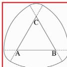
Una costruzione analoga a quella del triangolo permette di disegnare poligoni di Reuleaux con un numero dispari di lati che siano archi di circonferenza. Se invece si vogliono ottenere poligoni con un numero pari di lati, occorre usare archi di
