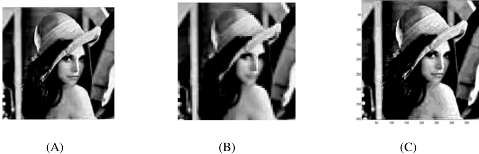
Figura 3. Esempio di immagine digitale (A); con una diversa risoluzione, più grossolana con la formazione di quadretti più grandi (B); con diversa quantizzazione dei livelli di grigio (C) con meno livelli.
