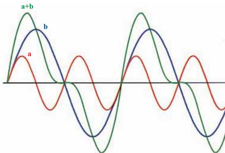
La somma di due onde (a e b) produce in genere una nuova onda (a+b) diversa dalle prime due
