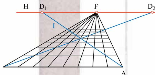
Il punto F non è il solo punto di fuga possibile: sul disegno, se ne possono trovare tanti quanti le direzioni da rappresentare.
